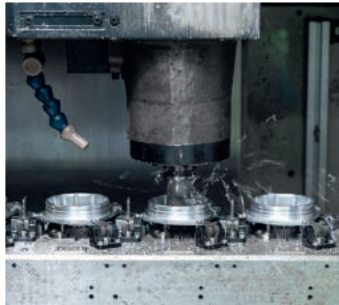
Trockenbearbeitung für ein Bauteil im Lenksystem
